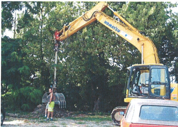
Abb. 1: Für das Vorprojekt werden im August 2009 zusätzlich zu den bereits vorhandenen Untersuchungen 40 Rammkernsondierungen zur repräsentativen Untersuchung des Deponieinhalts sowie 5 gezielte Grossaufschlüsse mittels Bagger vorgenommen.
