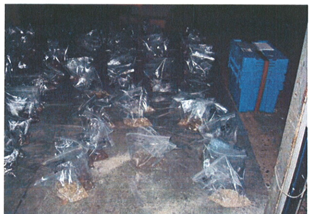
Abb. 3: Proben aus den Sondierungen und Baggeraufschlüssen zur Analyse im Labor
